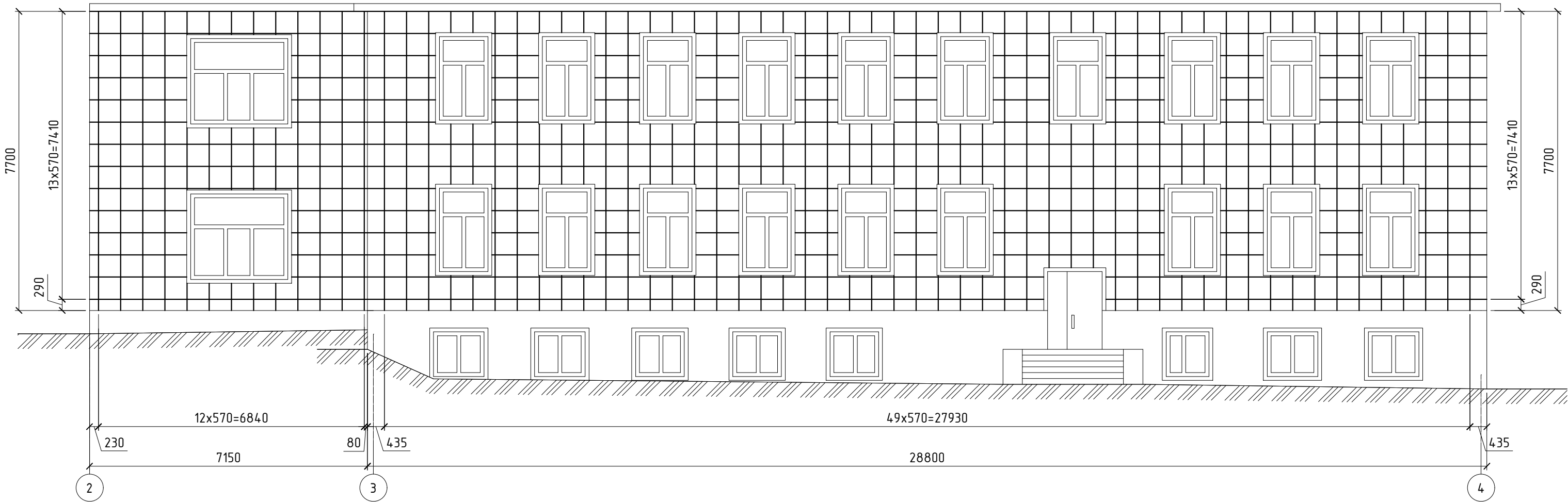
Схема раскладки металлокассет. Фасад в осях 4-1 М1:100
